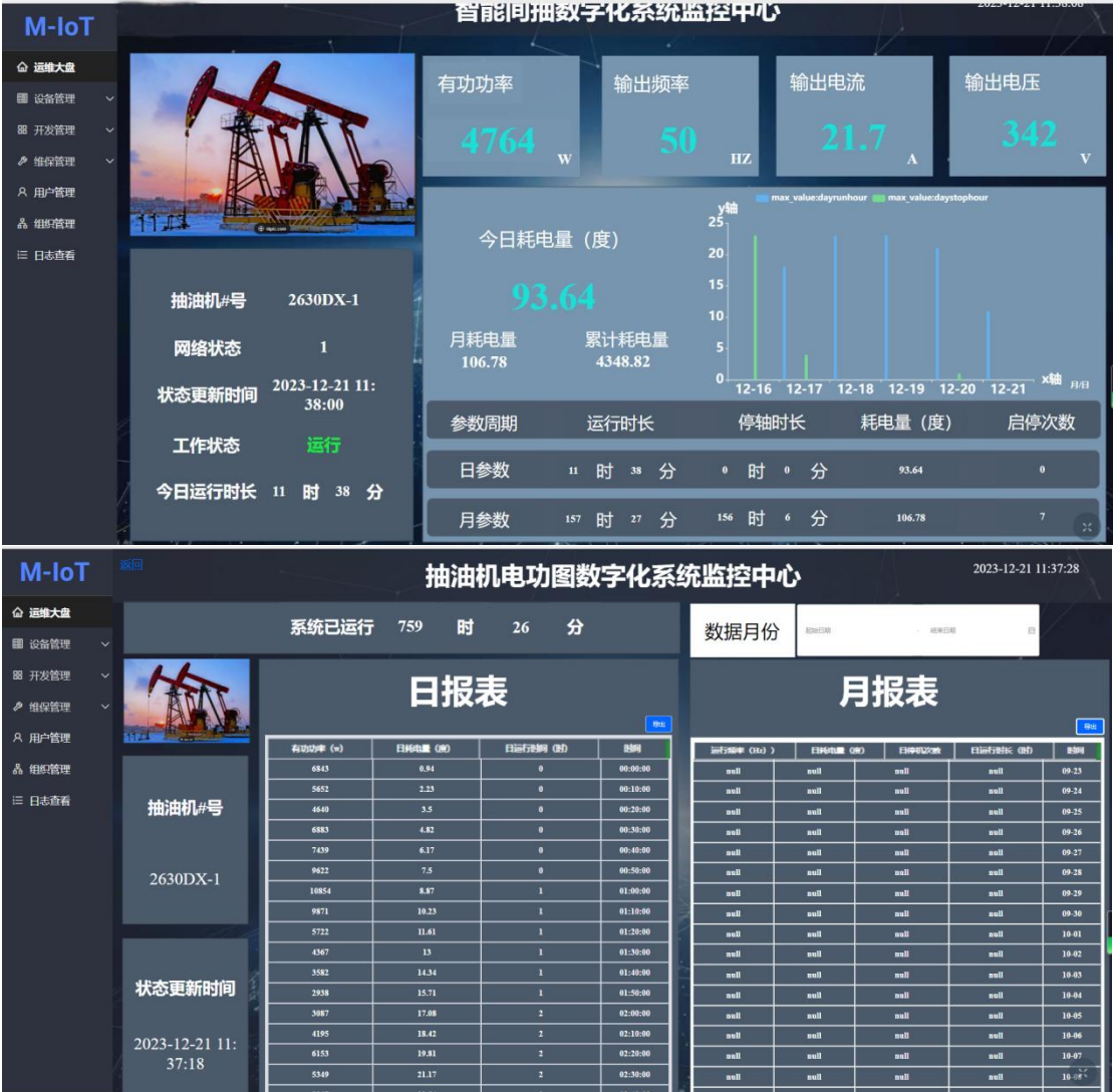
图2 新能源直流微电网的抽油机节能群控系统
