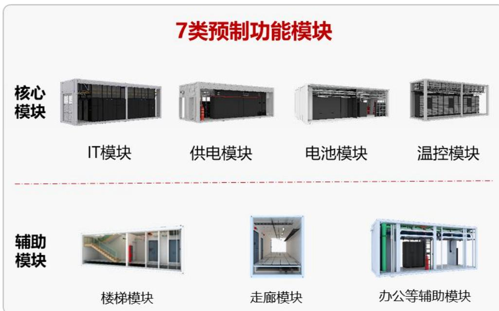
图 4 数据中心预制模块系统结构图
